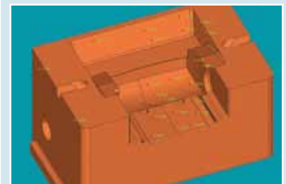
In der Bildschirmdarstellung des Soll-Ist-Abgleichs in der Maschine erkennt der Maschinenbediener sofort die Maßhaltigkeit und protokolliert seine Genauigkeit.
