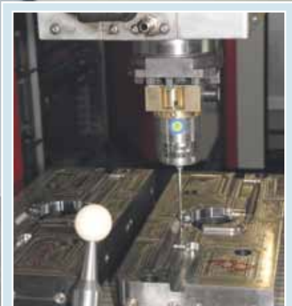
Bei Engesser werden Werkstücke auch auf der Senkmaschine erst aus der Spannung gelöst, wenn sie gemessen und als gut befunden sind.
