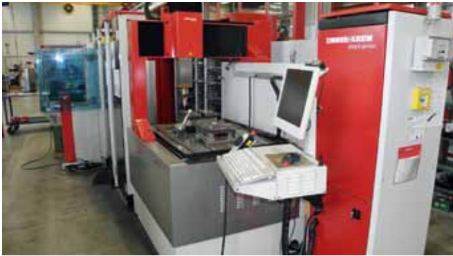
Eine verkettete Anlage von Zimmer und Kreim mit Messtastern und Software von m&h-Hexagon sorgt für Präzision und Produktivität.
