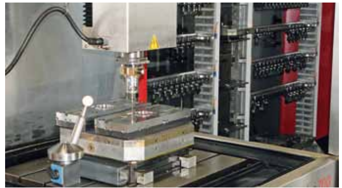
Messen der Werkstücke mit 3D Form Inspect schafft auch auf der Funkenerosionsmaschine in der verketteten Anlage Produktionssicherheit.
